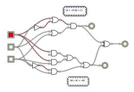
2. Si dimostri che  $x + \sim xy = x + y$ . Si implementino in gatesim i due circuiti corrispondenti a  $x + \sim xy$  e x + y e si verifichi la correttezza del risultato.
