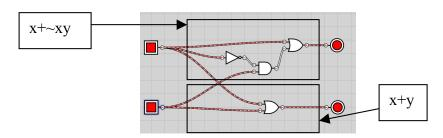
Il secondo circuito è migliore del primo sia rispetto al cammino critico (2 per il primo, 1 per il secondo) sia rispetto al costo circuitale (2 per il primo, 1 per il secondo).
